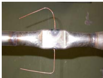
Att. 9. Kondukcijas MHD caurteces mēritājs augstām temperatūrām korozijas eksperimentu kontūram.
