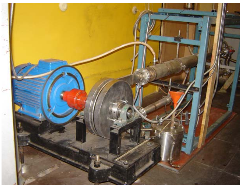
Att. 8. Indija-gallija-alvas stends EM sūkņu spiediena un caurteces raksturlīkņu mērīšanai.
