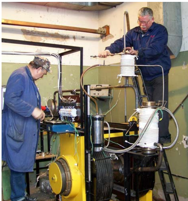
Att. 3. Korozijas stenda rekonstrukcija
