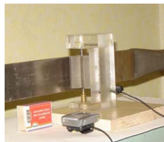
Att. 11. Caurteces mēritāji ar rotējošiem pastāvīgiem magnētiem: pirmais ir diska tipa , bet otrs cilindriska tipa caurteces mēritājs.
