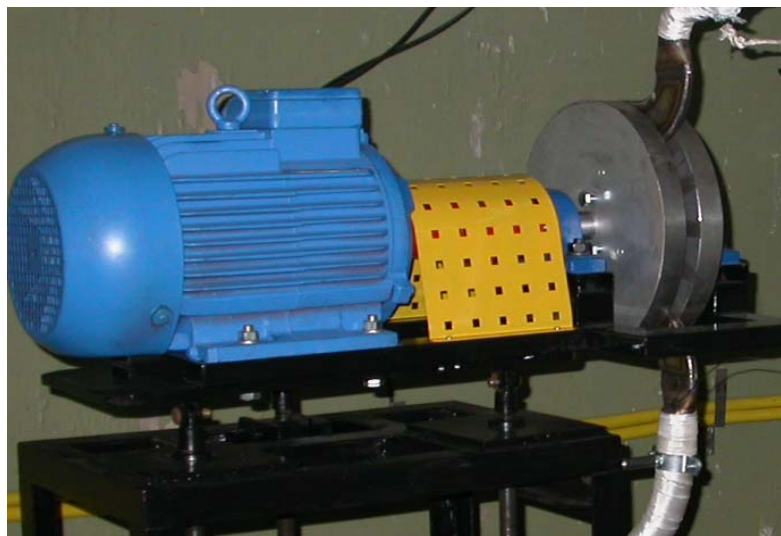
Att.7. Diskveidīgas konstrukcijas MHD indukcijas sūknis ar pastāvīgiem magnētiem.
