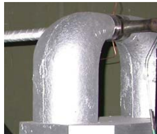
Att. 9. Kondukcijas MHD caurteces mēritājs augstām temperatūrām korozijas eksperimentu kontūram.
