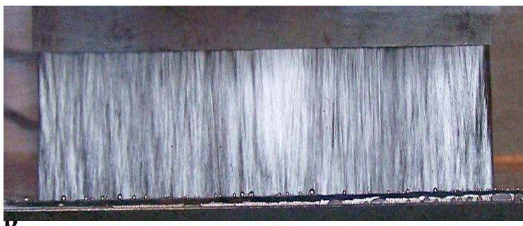
Att.5.23. Rotējoša mērķa elements instalēts dzīvsudraba kontūrā. a – elementa konstruktīvs izpildījums; b – dzīvsudraba strūkļa.
