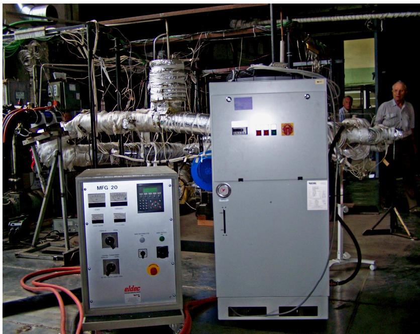
Att.5.4.Svina – bismuta (PbBi) kontūrs ar tanī instalētu „slīpa loga” tipa protonu - neutronu konvertora mērķi. (Priekšplānā augstfrekvences ģenerators (N = 20kW), kurš paredzēts lokālai mērķa zonas (Ø 100mm) uzkarsēšanai līdz temperatūrai aptuveni 700°C).
