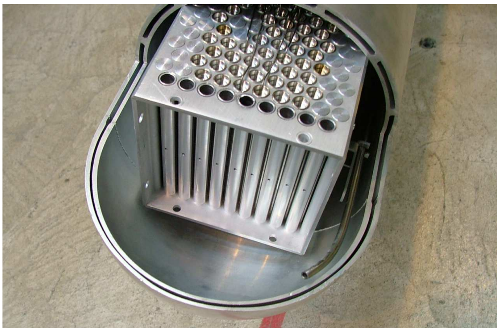
Att.2.5. Šveices neitronu avota svina protonu mērķis, kurā siltuma pārnese balstās uz konduktīvo siltuma pārnese nerūsējošā tērauda caurulē, kas daļēji aizpildīta ar svinu un ūdens kā dzesētāja konvektīvo siltuma pārnese. Parādīta mērķa konstrukcija [4].
